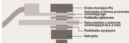
Widok szczegółowy połączenia uziemiającego:
